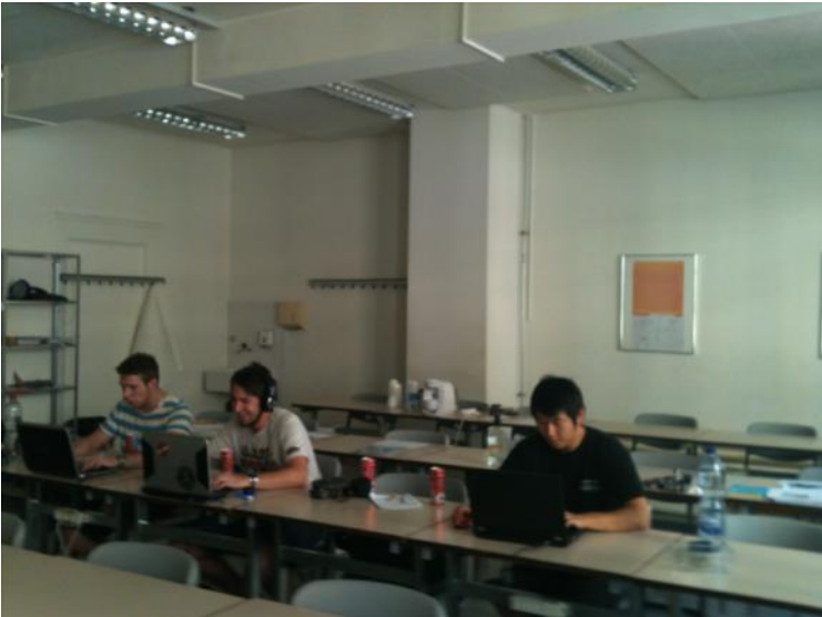
Zimmer W14, Boden: Linoleum, Mauerwerk, Decke: Platten, Fenster: Klappfenster, Beleuchtung: Neonröhren
