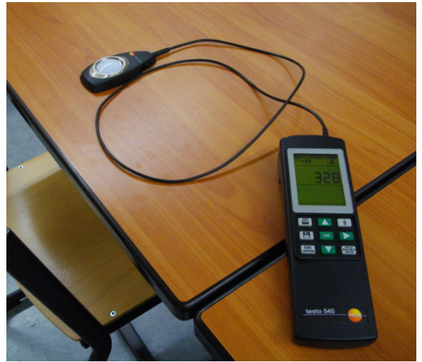
Abbildung 6 Beleuchtungsstärke: 328 lx (M3)
