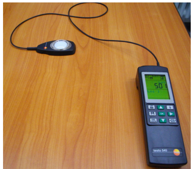
Abbildung 4 Beleuchtungsstärke: 501 lx (M1)
